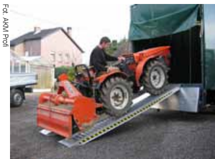
Najazdy dostosowane są do pojazdów kołowych i gąsienicowych
