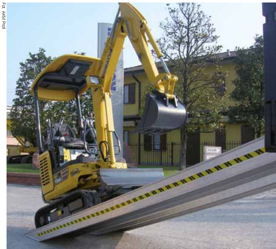
Najazdy aluminiowe AKM Profi mogą mieć długość od 1 do 5,5 m i nośność od 440 do 20000 kg
